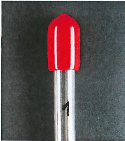
Foto 1: Prüfkörper mit Schutzkappen REF 01058 mit innen liegenden BI-Faden
