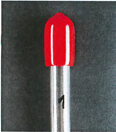
Foto 1: Prüfkörper mit Schutzkappen REF 01058 mit innen liegenden BI-Faden
