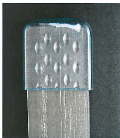
Foto 3: Prüfkörper mit Schutzkappe REF 01822/92119 BNS mit innen liegendem BI-Faden
