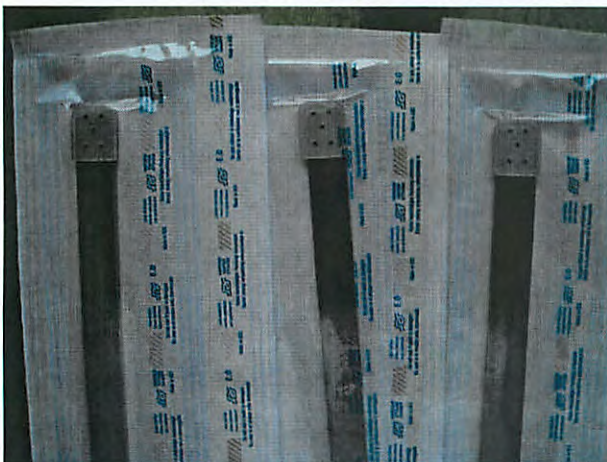
Foto 3: Proben mit Bioindikator, in Sterilisierverpackungen doppelt verpackt
