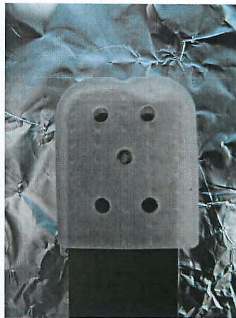
Foto 2: Meißel mit Schutzkappe und Bioindikator-Faden
