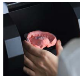
3Shape D700 Scanner zum direkten Scannen der Abformung
