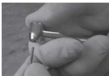
> Einsetzen des Drehwerkzeugs des Typs 3 (Winkelstück : 1 : 5)
