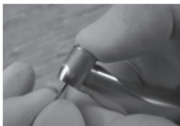
> Einlegen des Werkzeugs/Montage des Werkzeugs „Typs 1“ (Winkelstück 1:1 und 5:1)
