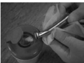
Le nettoyage du dispositif doit être réalisé immédiatement après l'intervention. Le contre angle doit être retiré du moteur. (voir §6.1) L'instrument rotatif doit être retiré du contre angle. (voir § 6.3).
